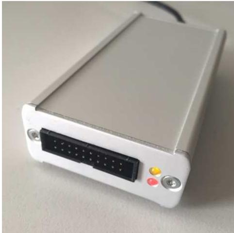
Für die Softwareentwicklung für ARM Prozessoren speziell mit der LPCXpresso IDE<sup>®</sup> oder anderen Plattformen, welche das CMSIS-DAP oder J-Link Protokoll unterstützen, stellt unsere ESiBOX eine robuste Adapterlösung auf Basis des LPC-LINK2<sup>®</sup> Moduls von Embedded Artists zur Verfügung.
